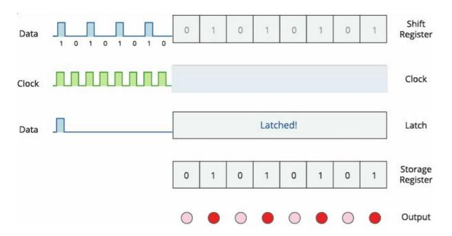
Q0-Q7: 8-битные выводы параллельного вывода данных, способные напрямую управлять 8 светодиодами или 8 выводами 7-сегментного дисплея.
