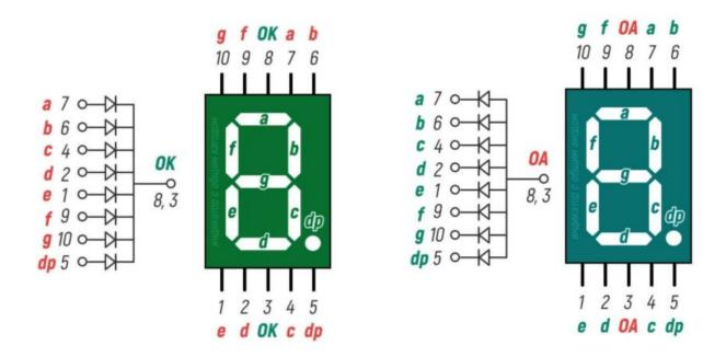
Семисегментный цифровой LED индикатор – это устройство, которое состоит из семи светодиодов, установленных в форме цифры 8. Включая или выключая соответствующие светодиоды (сегменты) можно отображать цифры от 0 до 9, а также некоторые буквы.
