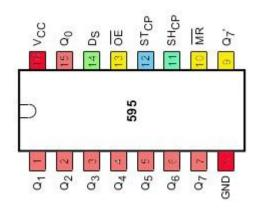
Чип преобразовывает входящий последовательный сигнал на 1 пине (Ds) в выходной параллельный на 8 пинах (Qx). Последовательная передача синхронна: для такта используется дополнительный пин (SHcp). Также отдельным пином управляется регистр данных (STcp), что позволяет изменять сигнал на 8 выходах единовременно, когда все данные переданы.
