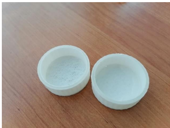
Рисунок 2 – Форма для шин с залитым силиконом
