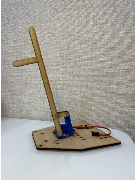
Рисунок 6.1 - Версия 2 механизма сбивания планки (вид с левого боку)
