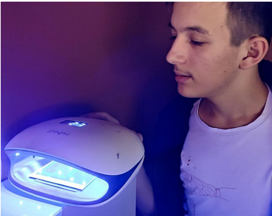
Рисунок 3.6 — Метод фоторезист: экспонирование композита в ультрафиолете
