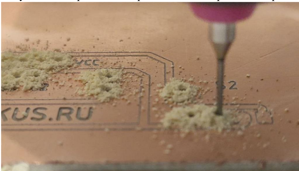
Рисунок 3.16 — Метод фрезеровки: процесс сверловки платы
