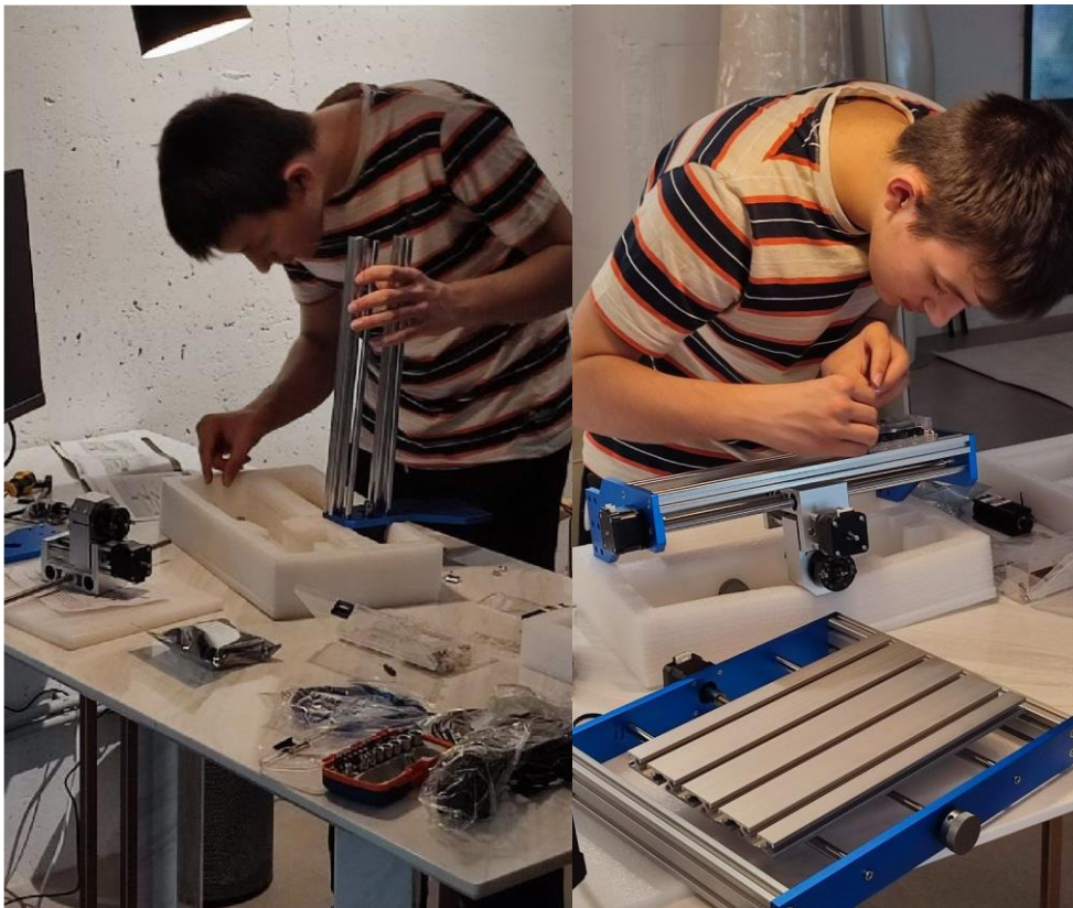
Рисунок 3.11 — Метод фрезеровки: сборка станка
