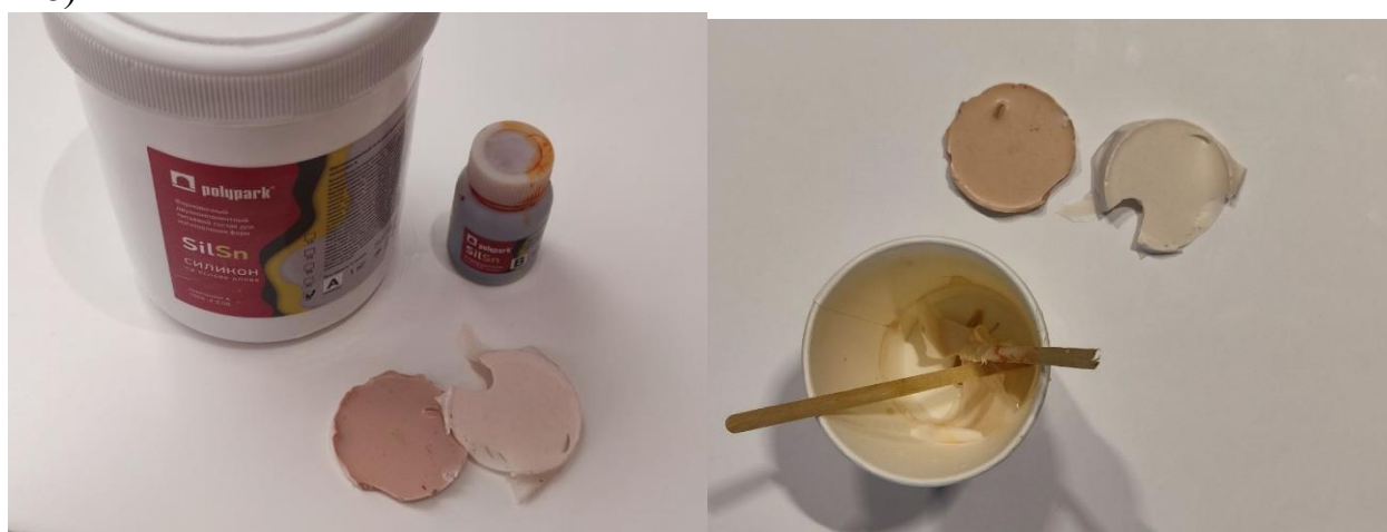
(Рисунок 2.8). – пробные фрагменты заливки с разной пропорцией компонентов
