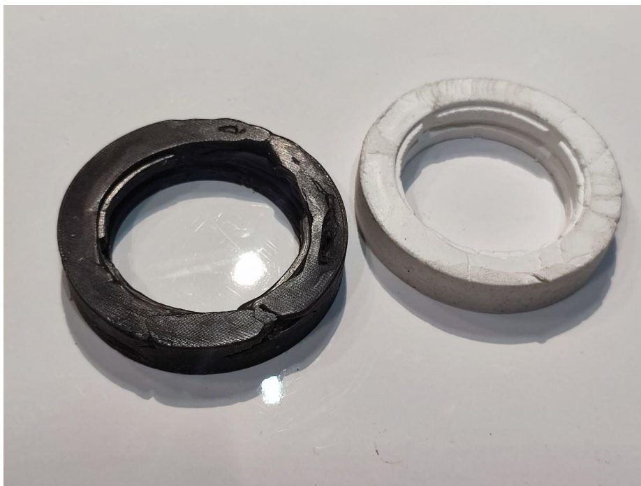
Рисунок 2.7 — Шины из санитарного силиконового герметика: слева Litokol SA цвета антрацит, справа - Master Teks ProfiMaster Белый
