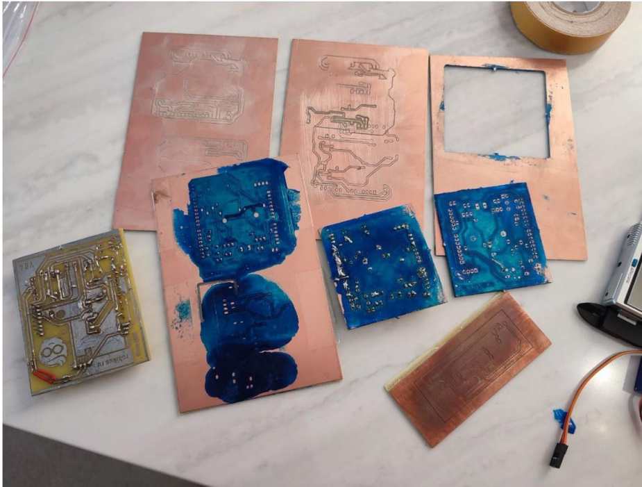
Рисунок 3.18 — часть неудачных или ошибочных вариантов плат. На мой взгляд, основная проблема при фрезеровке плат заключается в толщине границы, отделяющей контактную дорожку от остальной поверхности и соседних дорожек.
