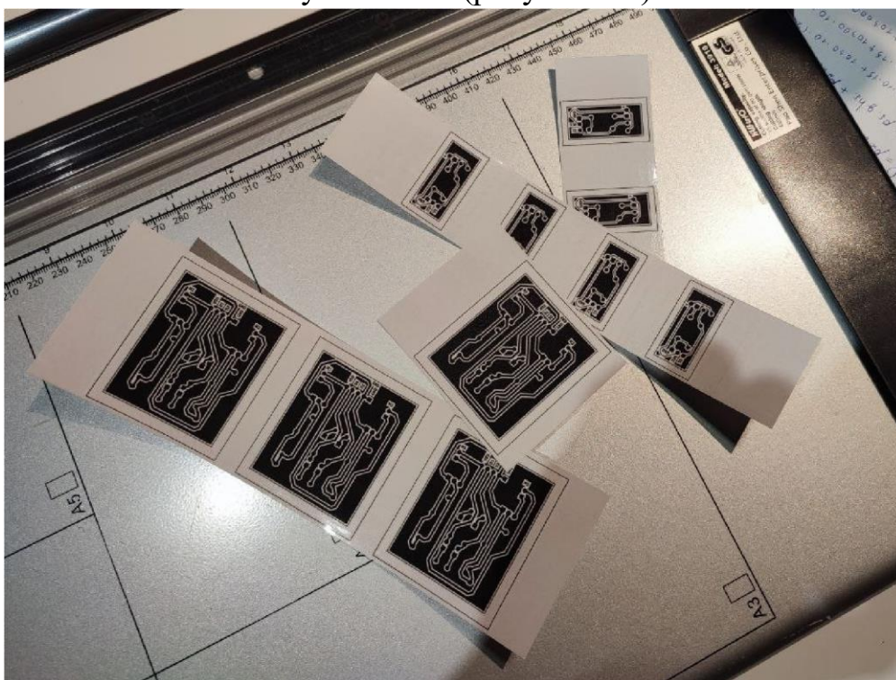
Рисунок 3.4 — Метод фоторезист: лазерная печать макета на прозрачной пленке
