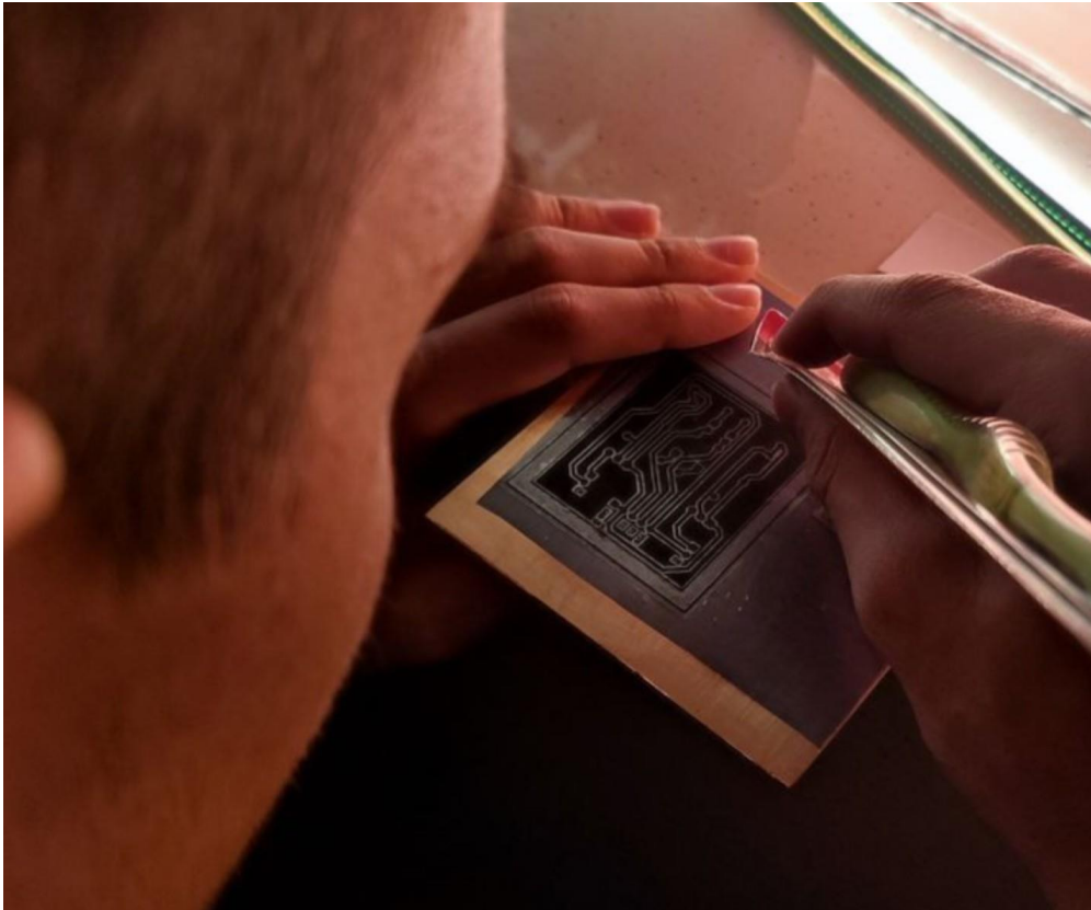
Рисунок 3.5 — Метод фоторезист: перенос фоторезистивной пленки и шаблона на стеклотекстолит
