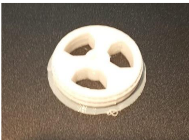
Рисунок 1 — колесо, распечатанное на 3D принтере
